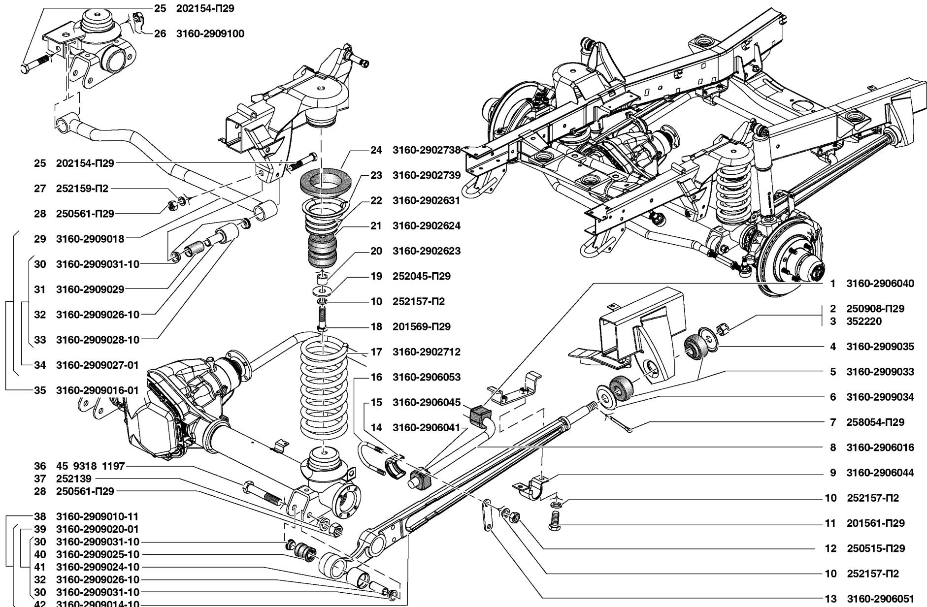
Рис. 73. Пружины передние (2902), стабилизатор поперечной устойчивости (2906), штанги реактивные передней подвески (2909)
