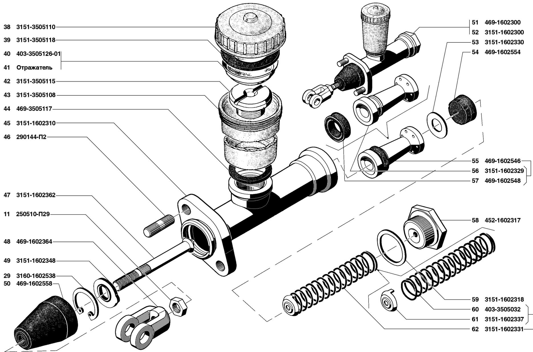
Рис. 50. Привод выключения сцепления (1602)/2
